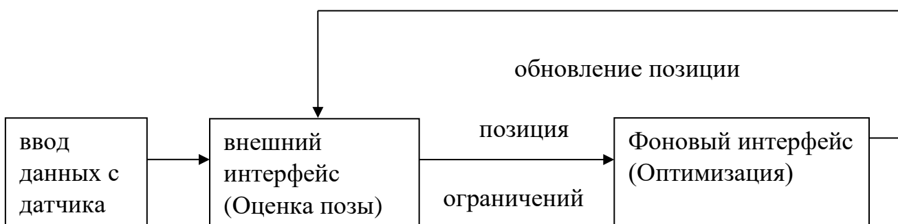
Рисунок 2.1 - Общая структура на основе графика обнаружения света и определения дальности (SLAM)
