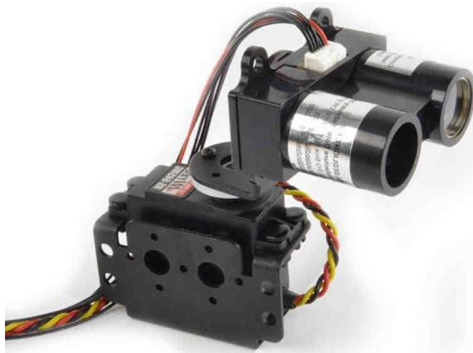
Рисунок 4.7 – Системный вид положение LIDAR на сервоприводе
